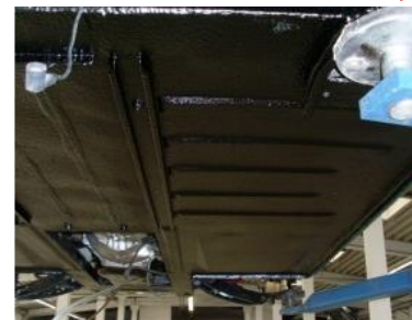
Neuer Unterboden rechts
