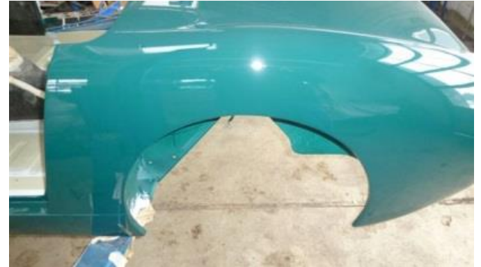
Kotflügel hinten links nach Lackierung
