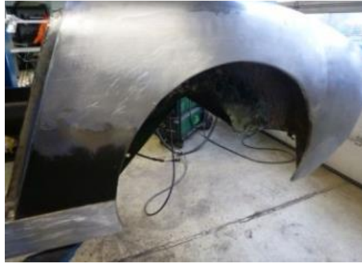
Kotflügel hinten links mit Reparaturblech und verzinkt
