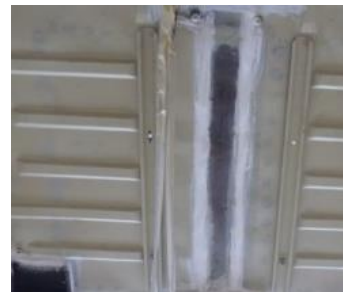
Unterboden mit Nahtabdichtungen
